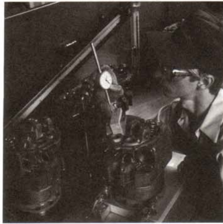
写真4 バルブのガタ測定
